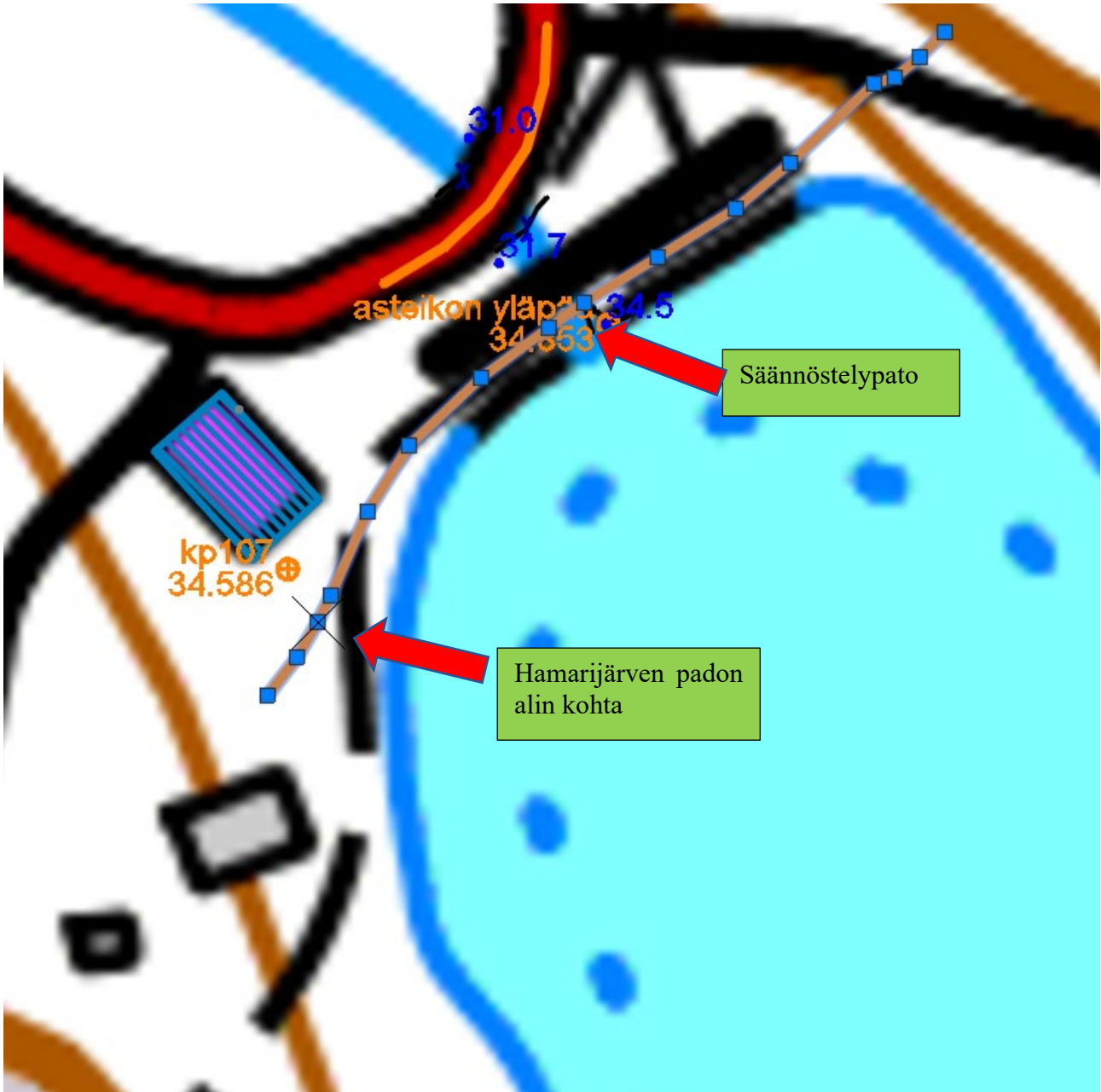
Kuva 6. Hamarijärven säätöstelypato ja padon harjan alin kohta kuvassa. (Taustakartta Maanmittauslaitos 02/2020)
